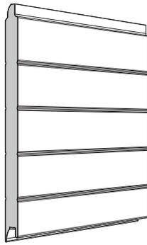
Unutarnji izgled panela h=500 mm
