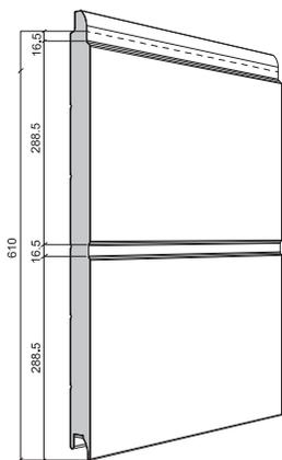
Vanjski izgled panela h=610 mm
