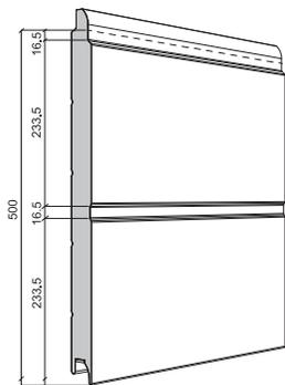
Vanjski izgled panela h=500 mm
