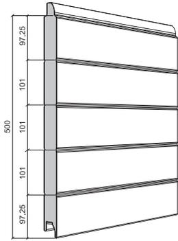
Vanjski izgled panela h=500 mm
