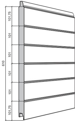
Vanjski izgled panela h=610 mm
