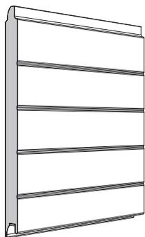
Vanjski izgled panela h=500 mm
